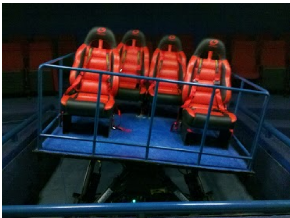
Figura 8.5: Fotografia de instante de máxima rolagem da plataforma em simulação
