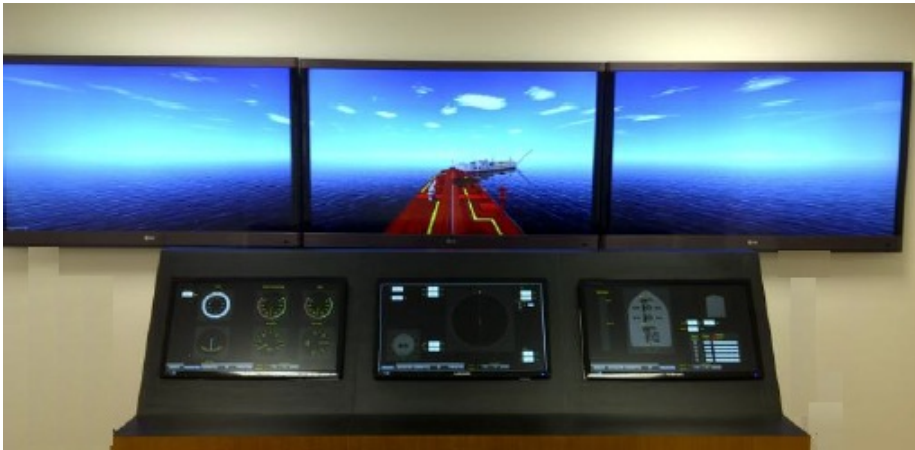
Figura 6.6: Simulação da ponte de comando desenvolvida
