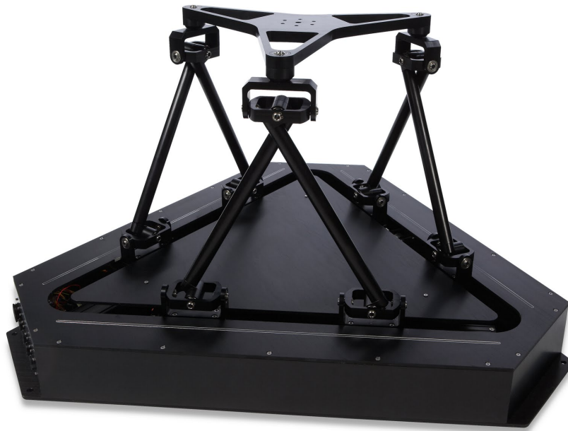
Figura 1.4: Plataforma tipo Hexapod ( www.quanser.blogspot.com.br )
